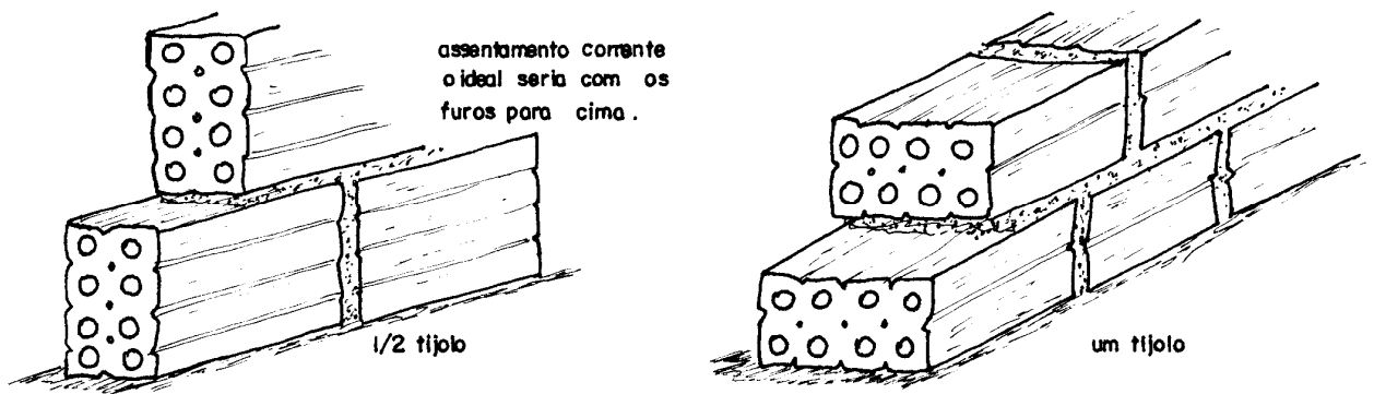
Figura 1 - Execução de alvenaria utilizando tijolos furados.
