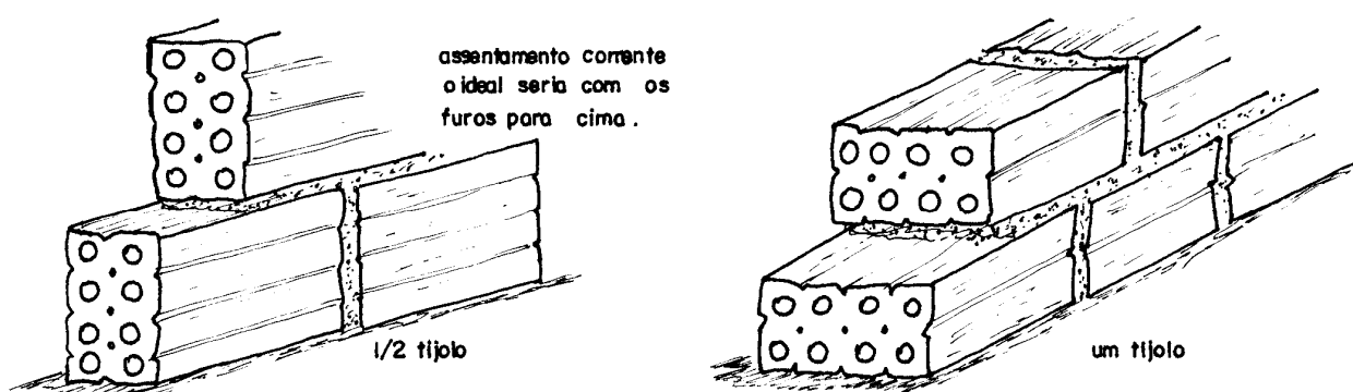
Figura 1 - Execução de alvenaria utilizando tijolos furados.
